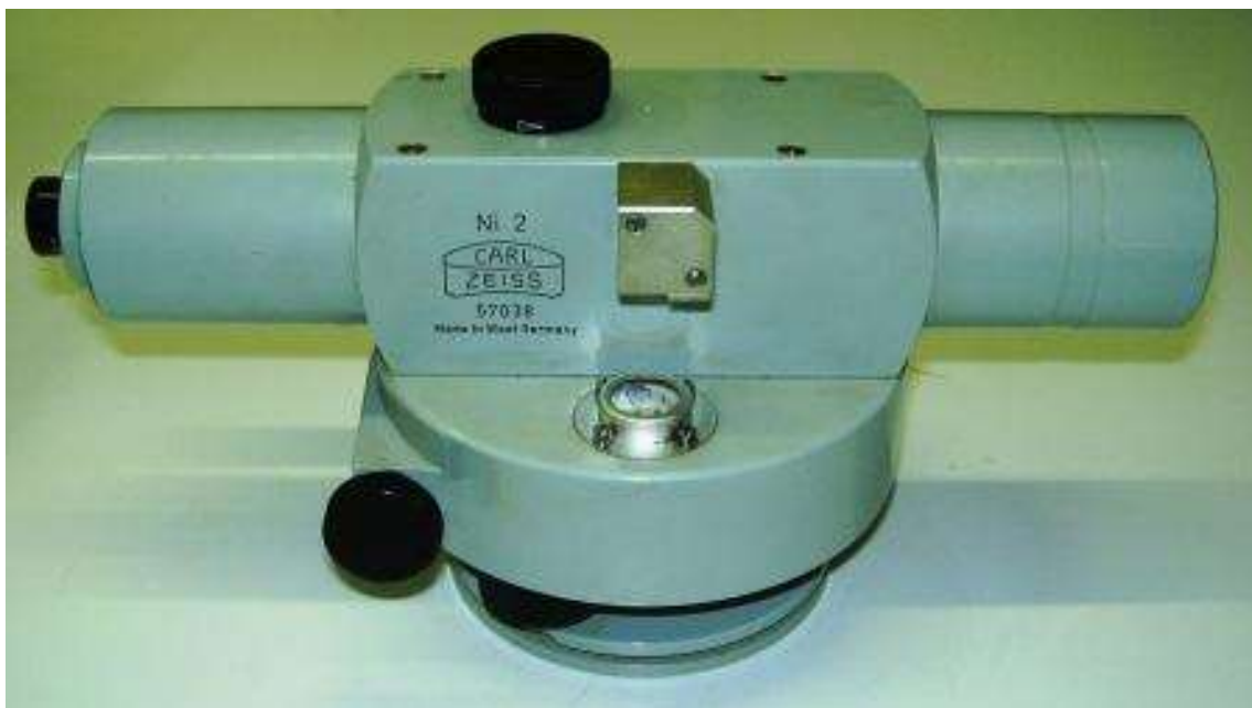
Figura 07: Nível de Luneta (topográfico) Fonte: Universidade Estadual de Campinas (2020).
