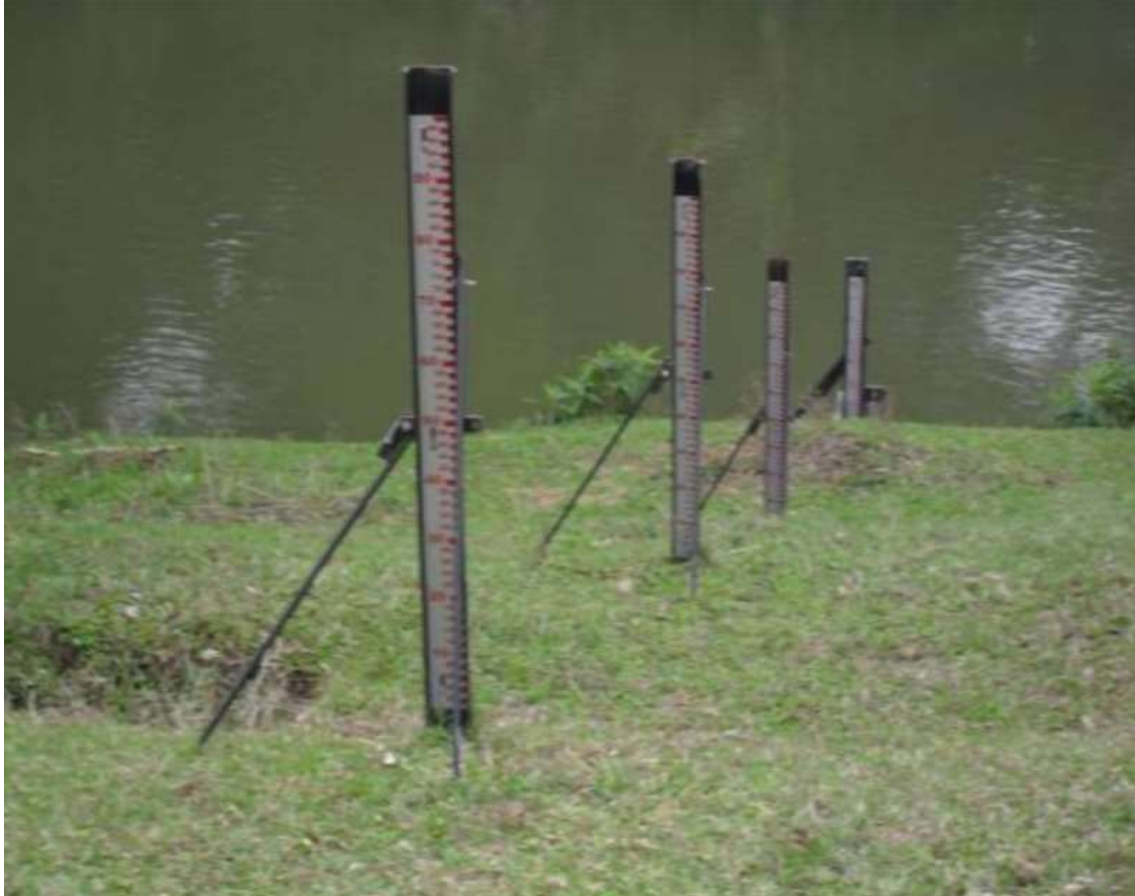
Figura 40: Exemplo de seções de réguas instaladas segundo os padrões da ANA.
